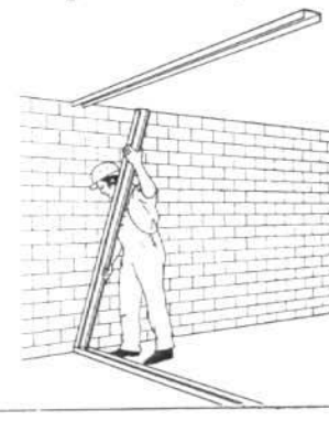
7. ábra Befoglaló keret UW profilokból
