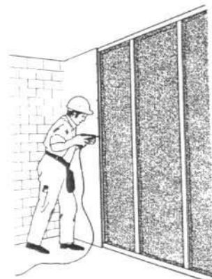
11. ábra Lezárás Rígips lapokkal
