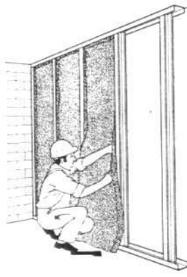
10. ábra Szigetelőpaplan elhelyezése
